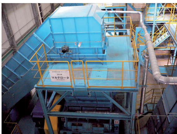
RPF 製造用の破碎機（マルチロータ）
