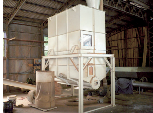
乾燥後原料の貯蔵サイロ（スクリュウホッパー）、容量 3m 3
