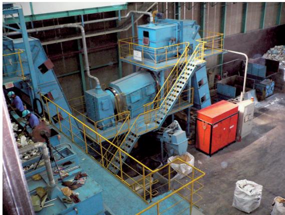
破碎機（奥）、磁選機及び目視選別ライン（手前左）
