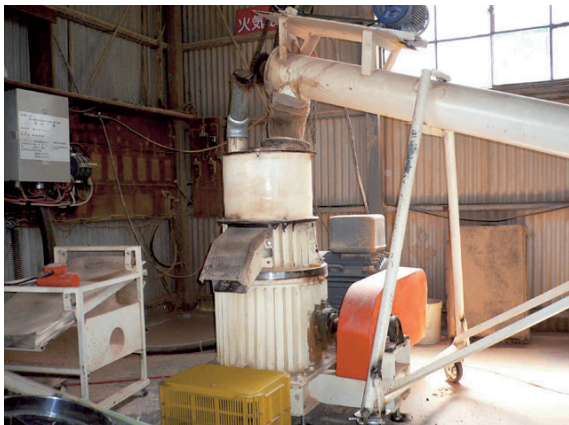
ペレット成型機 ロール展圧方式
