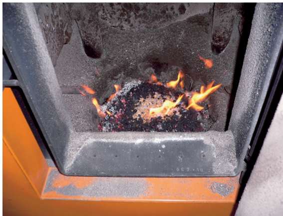
燃焼炉内で燃焼するペレット
