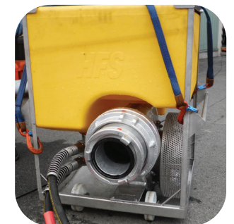
水中ポンプにより取水
