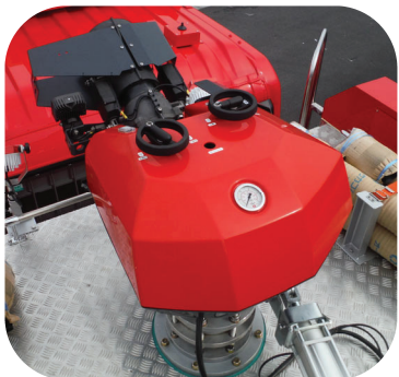
放水砲(能力:8000ℓ/分)
