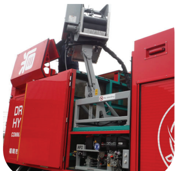
延長したホースを回収する装置
