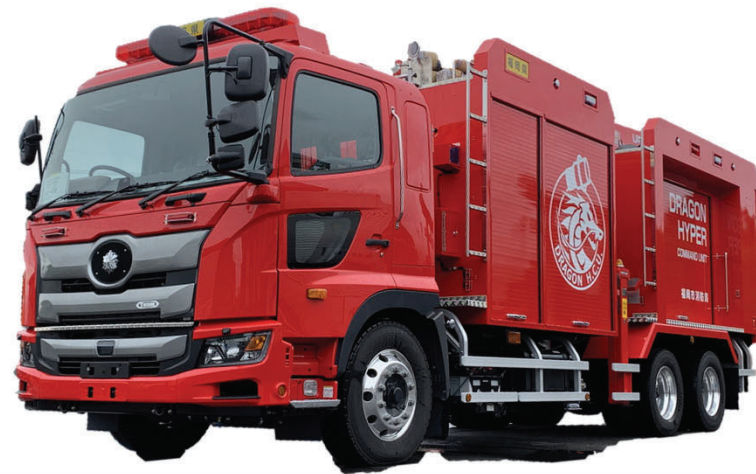
大容量送水ポンプ車
