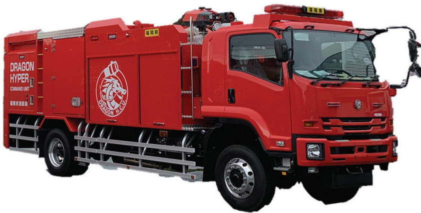
大型放水砲搭載ホース延長車
