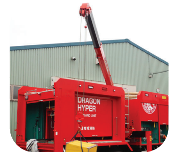
車両上部にクレーンが設置
