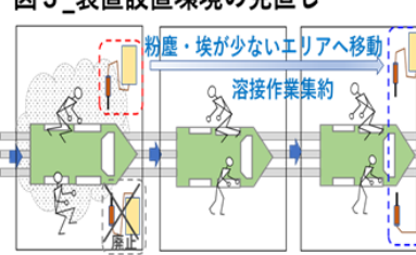
図3 装置設置環境の見直し
