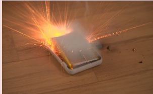
モバイルバッテリー火災の再現映像
