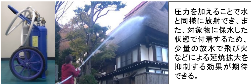
木造密集地及び伝統的建造物の延焼防止のための 高粘度液体放射装置
