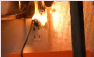
プラグがショート（トラッキング現象）し火災に至る再現実験の様子
